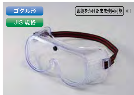
防じんメガネ No.1270 クリア くもり止め加工レンズ使用。 ●フレーム：軟質塩化ビニル（透明） ●レンズ：ポリカーボネート 0.8mm厚 ●重量約 58g ●くもり止め加工レンズ
