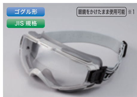
防じんメガネ No.1390 グレー x クリア くもり止め加工・UVカットレンズ使用。開閉ベンチレーション付き。 ●ヘッドバンド：織ゴム（25mm幅） ●レンズ：強化ポリカーボネート ●重量約 95g ●くもり止め加工レンズ ●UVカット ●フレーム：ポリプロピレン+エラストマー（接顔部）
