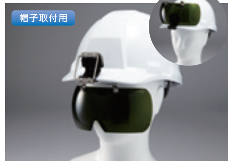
帽子取付用メガネ No.1400-G（防じん用・ガス溶接用） 紫外線・赤外線しゃ光用。ヘルメットのひさしに差し込むだけ。 ●レンズ：ポリカーボネート（グリーン） ●重量約：85g ●UVカット ●赤外線用（しゃ光度 #4標準） ●特殊ハードコーティング加工レンズ
