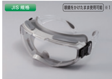
JIS 規格 ※1 防じんメガネ No.1395 グレー x クリア くもり止め加工・UVカットレンズ使用。開閉ベンチレーション付き。 ●つる：ポリカーボネート（一部軟質塩化ビニル） ●レンズ：強化ポリカーボネート ●フレーム：ポリプロピレン+エラストマー（接顔部） ●重量約 96g ●くもり止め加工レンズ ●UVカット
