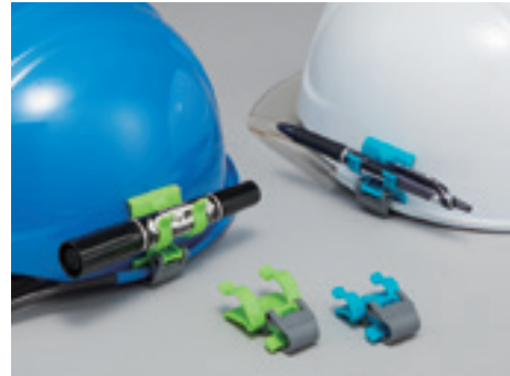
マーカーホルダー DP-1702 溝付き・MP型保護帽両用 ●径15~19mmまで対応 ●材質：ポリアセタール ペンホルダー DP-1703 溝付き・MP型保護帽両用 ●径8~11mmまで対応 ●材質：ポリアセタール
